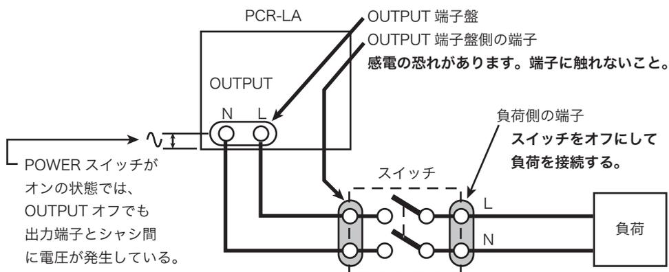
図 2-21 OUTPUT 端子盤と負荷間のスイッチ
