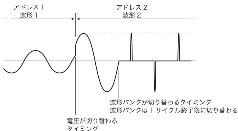
図 9-2 電圧と波形バンクの切り替わるタイミングの例
