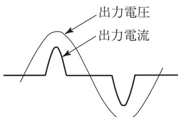
図8-4 コンデンサインプット型整流回路の波形
