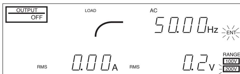
図 2-17 電圧レンジ切り替え (100 V → 200 V)
