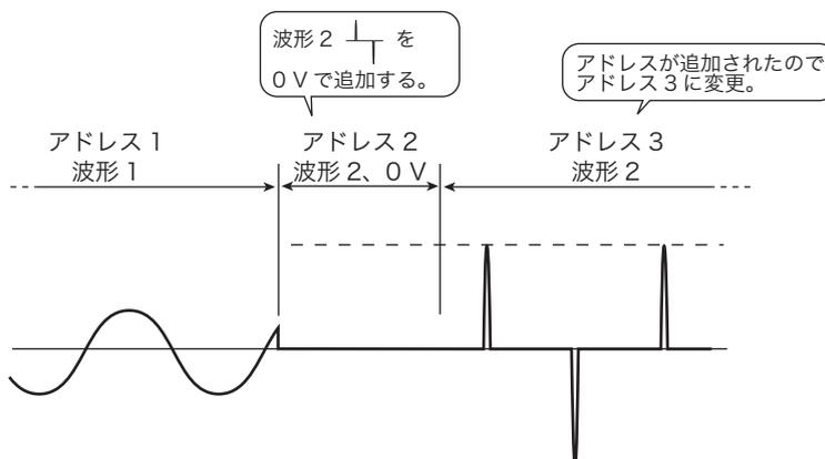
図 9-3 出力調整した波形の切り替わり
