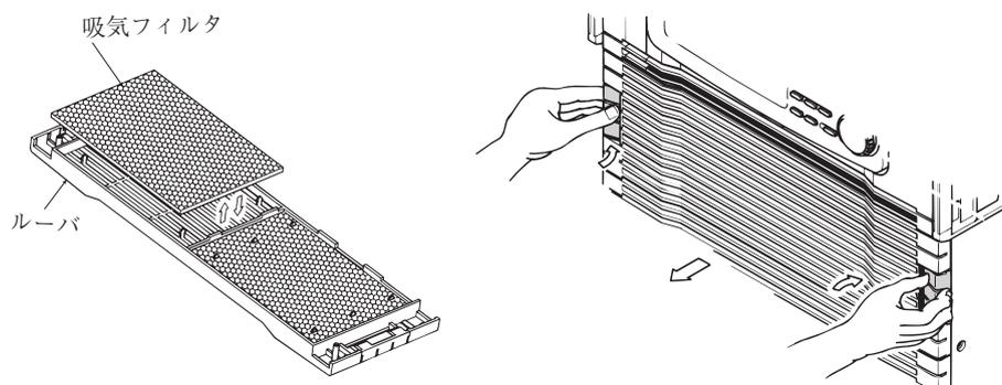
図 7-1 ルーバの取り外しおよび吸気フィルタ
