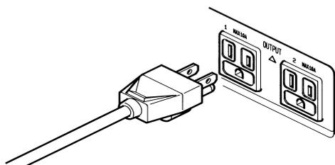
図 2-22 OUTPUT コンセントへの接続
