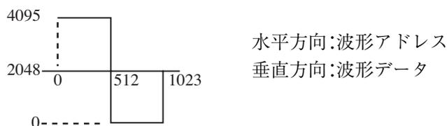
図 9-4 方形波を作成したときの例
