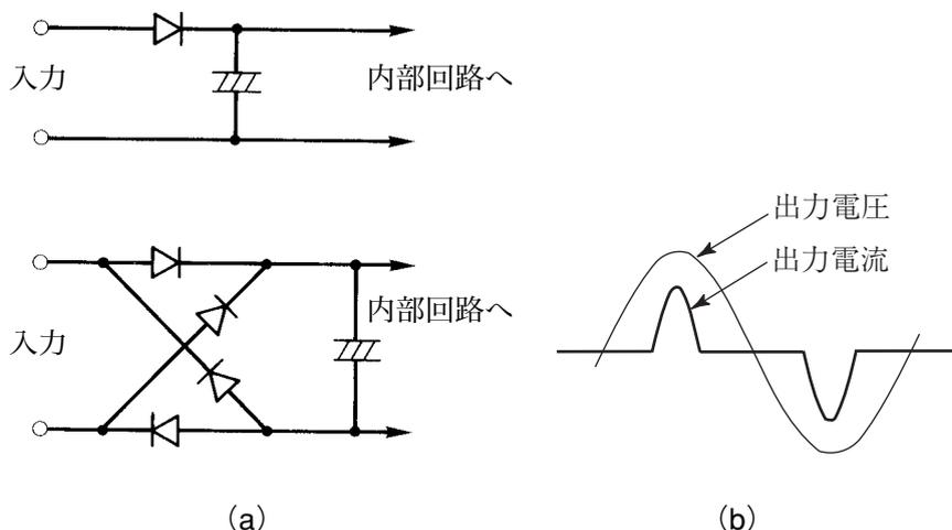
図 A-3 コンデンサ入力型整流（回路）負荷
