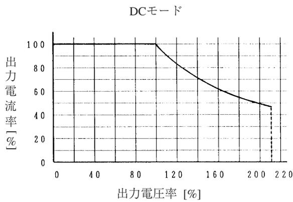
図 11-2 出力電圧率一定格出力電流特性 (DC モード)
