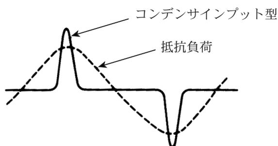
図 A-1 出力電流波形の例
