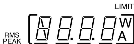
図 4-2 電流・電力表示エリア
