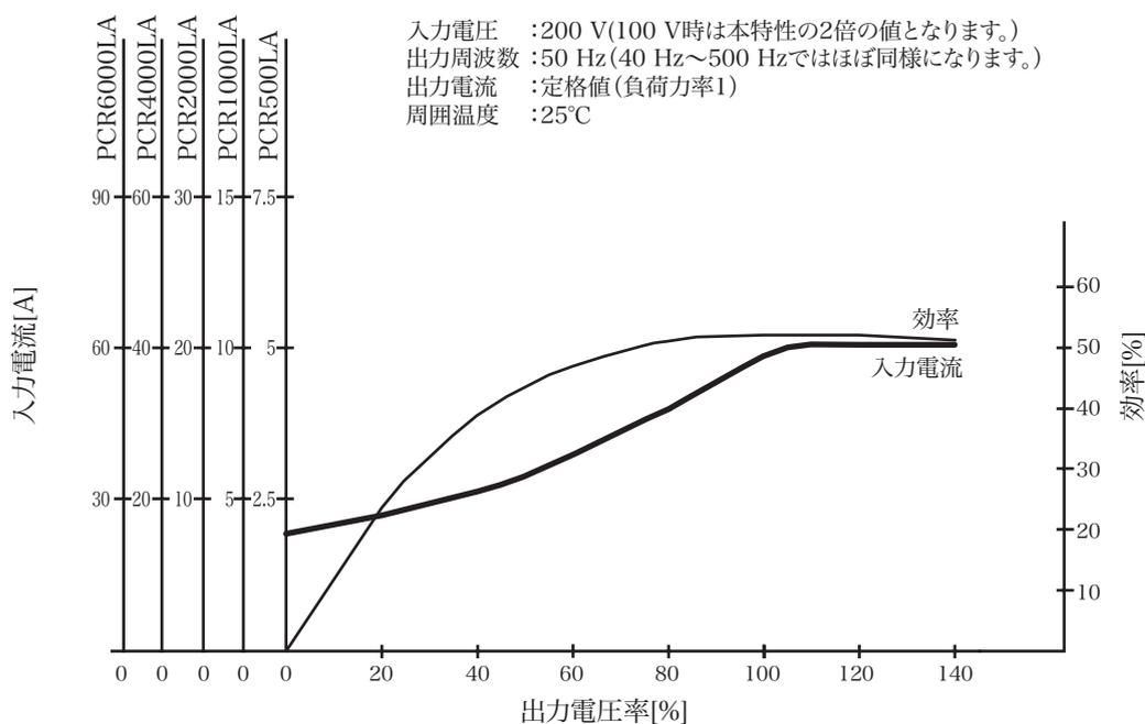
図 11-6 出力電圧—入力電流、効率特性 (AC モード標準値)
