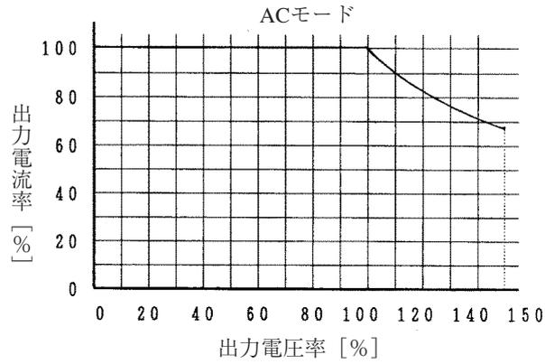
図 11-1 出力電圧率一定格出力電流特性 (AC モード)
