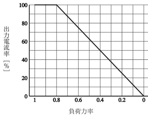
図 11-3 負荷力率一定格出力電流特性
