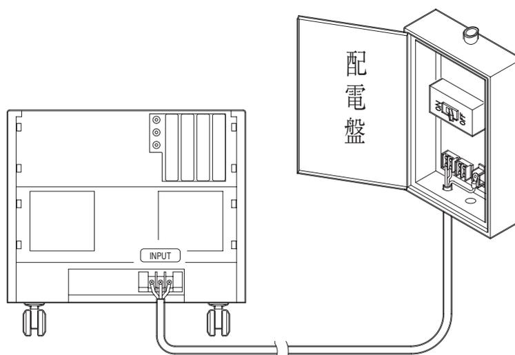
図 2-8 入力電源ケーブル（配電盤側）
