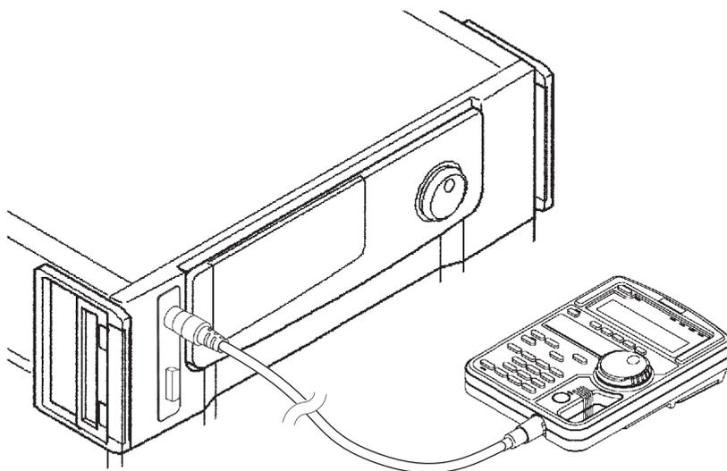
図1-2 本体とリモートコントローラ接続図
