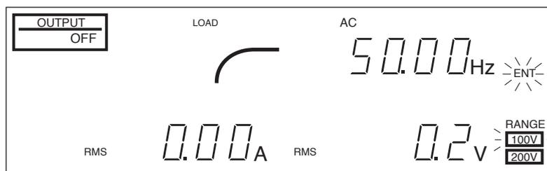
図 3-6 200 V レンジから 100 V レンジに切り替える場合。確定前は 100 V が点滅。
