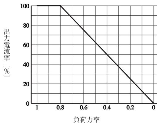
図 8-2 負荷力率対定格出力電流
