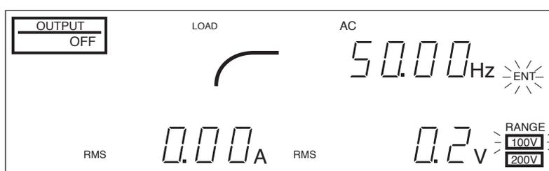
図 2-18 電圧レンジ切り替え (200 V → 100 V)
