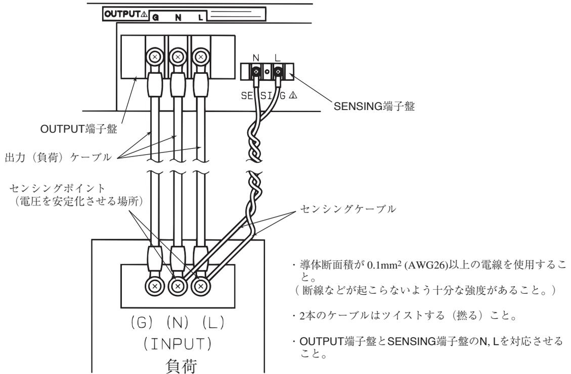
図4-11 センシング端子盤の結線方法
