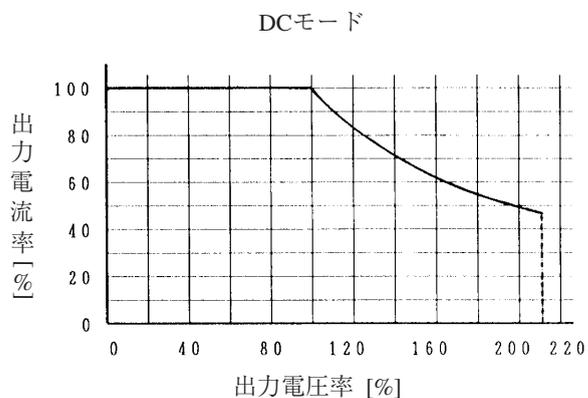
図 8-5 出力電圧率対定格出力電流：DC モード
