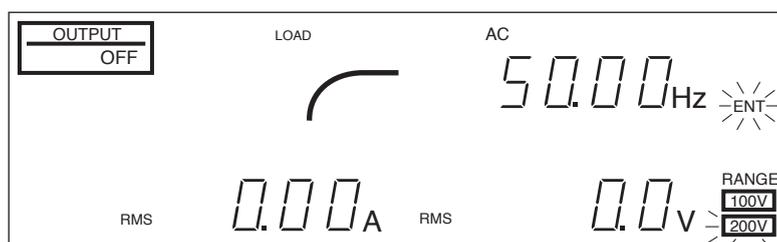
図 3-5 100 V レンジから 200 V レンジに切り替える場合。確定前は 200 V が点滅。
