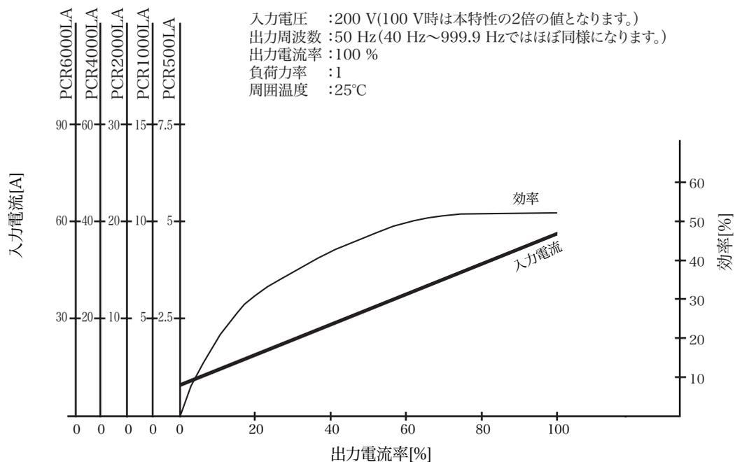
図 11-5 出力電流—入力電流、効率特性 (AC モード標準値)
