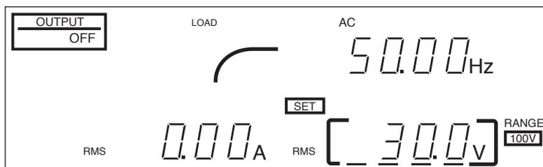
図 2-16 枠の動作、設定可能部分の表示
