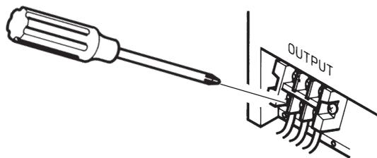
図 2-19 OUTPUT 端子盤への接続
